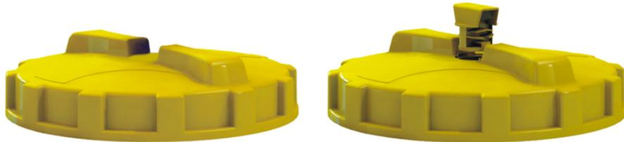
Ёмкости комплектуются **винтовыми инспекционными крышками** двух типоразмеров: до 3000л - **диаметр крышки 360мм**, от 3000л до 25000л - **диаметр крышки 500мм**. Инспекционные крышки существуют двух модификаций - со встроенным "дыхательным" клапаном и без него. **"Дыхательный" клапан** выравнивает давление, чтобы при сливе не создавалось разряжение, а при наполнении не создавалось избыточное давление. При длительном хранении воды клапан необходим для вентиляции.
